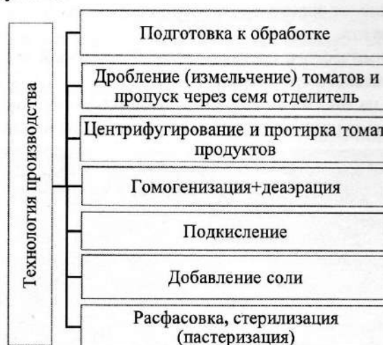
Рис. 3. Усовершенствованная технология производства томатного сока с использованием центрифуги
