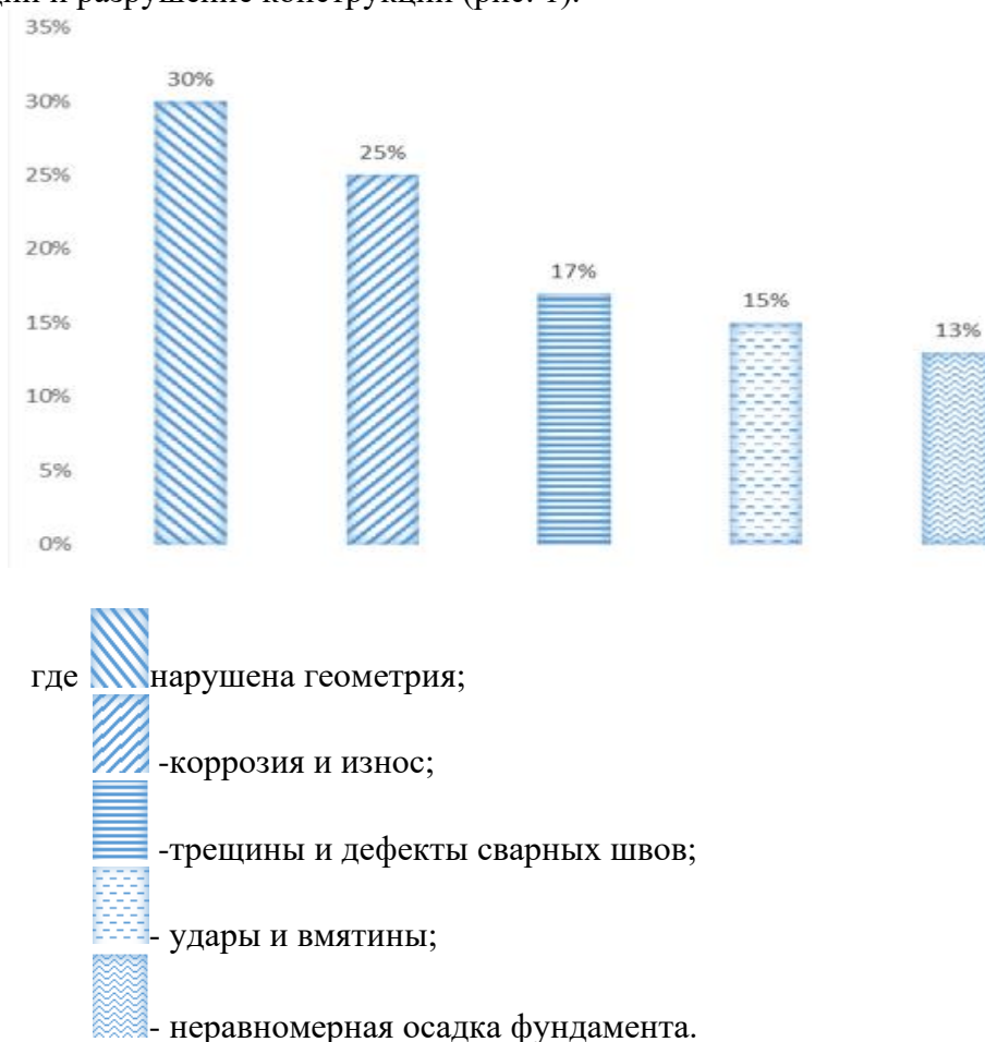
Рис. 1. Дефекты РВС и повреждения, приведшие к аварии
