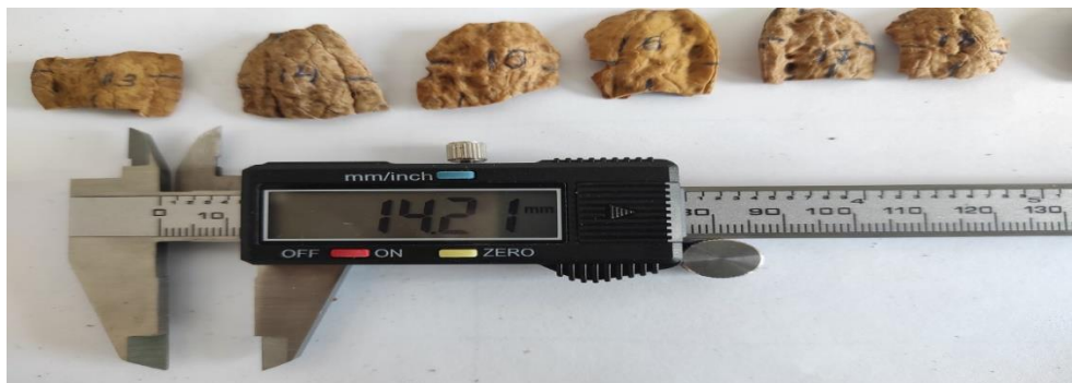
Рис. 3. Измерение размера скорлупы с использованием штангенциркуля ЕРМАК МТ-027
