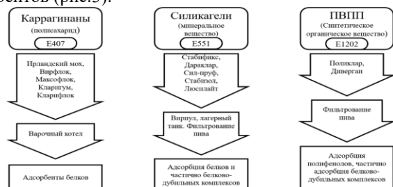
Рис. 3. Схема адсорбентов применяемых в пивоварении
