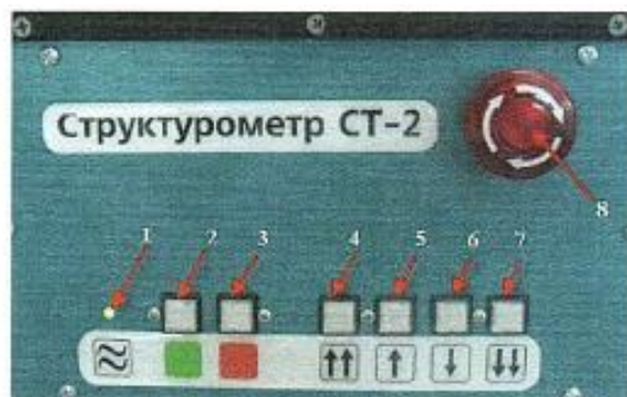
Рис. 1. Панель управления Структурометра СТ-2: 1 – светодиод; 2 – кнопка «Старт»; 3 – кнопка «Стоп»; 4 – кнопка «ускоренное перемещение тензобалки вверх»; 5 – кнопка «Средняя скорость»; 6 – кнопка «Средняя скорость движения вниз»; 7 – кнопка «Ускоренное перемещение тензобалки вниз»; 8 – кнопка «Аварийный стоп».
